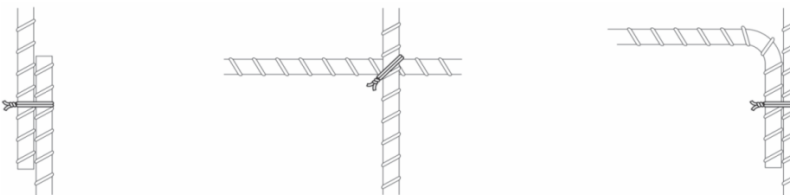
د- اتصال با سیم معمولی ۲۶ (مناسب فقط برای اهداف EMC) شکل ۲: روش‌های متداول برای اتصال صحیح میله‌گردهای داخل بتن
